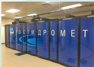
Cray/T-Platforms на базе XC40-LC (2018), Росгидромет, 1.3 Пфлопс
