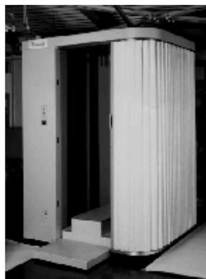
**Рис. 3.7.** Сканирующее устройство трёхмерной визуализации Body Line Scanner (Hamamatsu Photonics, Япония)
