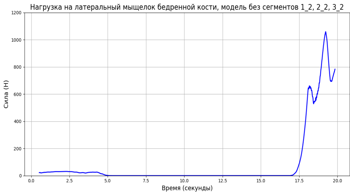
Рисунок 6.35 – График распределения нагрузки на латеральный мыщелок бедренной кости в модели без сегментов 1_2, 2_2, 3_2
