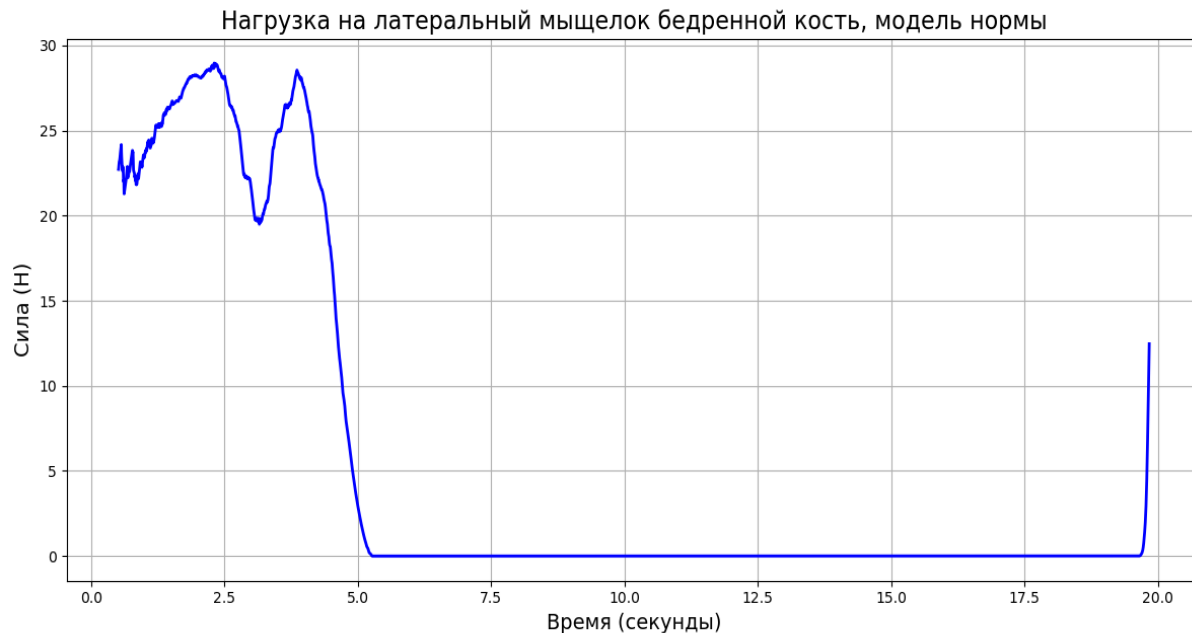
Рисунок 6.24 – График распределения нагрузки на латеральный мыщелок бедренной кости в модели физиологической нормы
