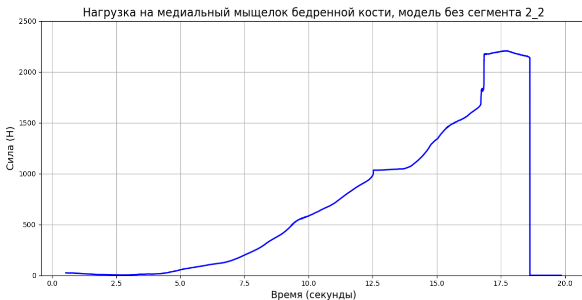
Рисунок 6.27 – График распределения нагрузки на медиальный мыщелок бедренной кости в модели без сегмента 2_2
