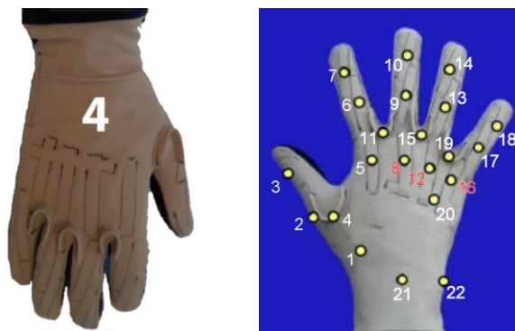
Рисунок 3.4 – Перчатка CyberGlove II на руке участника эксперимента (фотография), схема устройства перчатки и расположения датчиков. [33-34]
