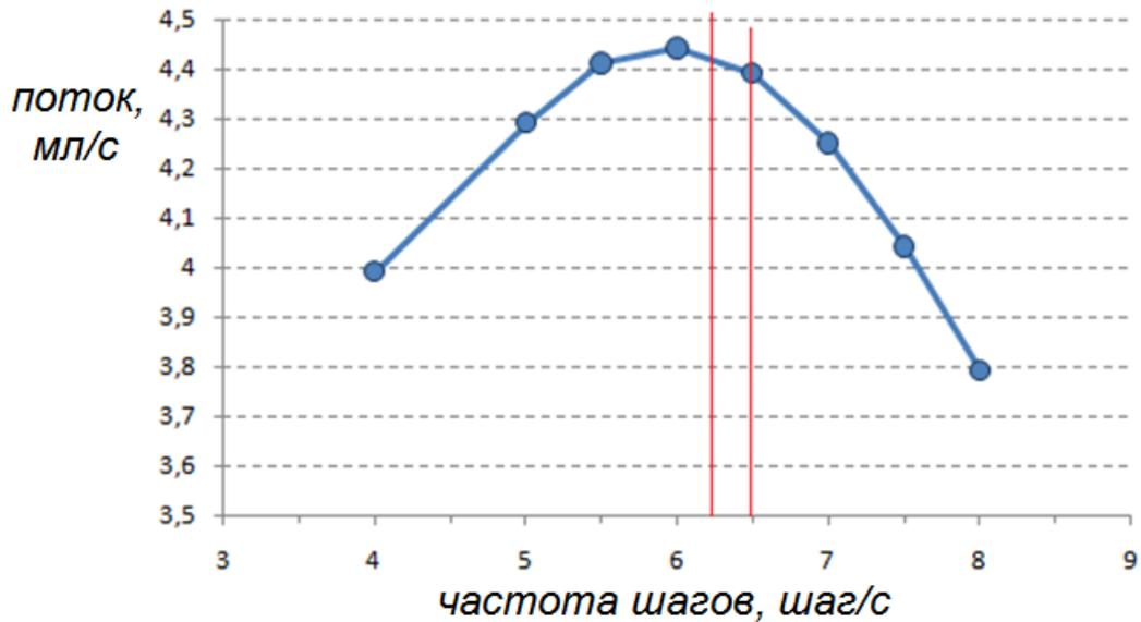
Рисунок 4.14: Зависимость потока от частоты шагов у модели, соответствующей спортсмену-спринтеру ростом 132 см. Вертикальные линии — диапазон характерных частот шагов атлетов-спринтеров, участвовавших во Всемирных Играх Карликов.
