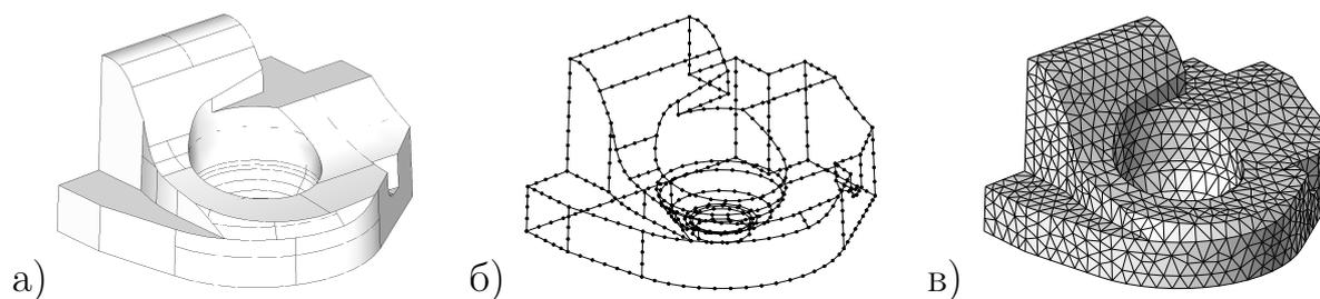
Рис. 1. Модель, заданная в САПР: а) геометрическая модель, б) дискретизация криволинейных рёбер, в) поверхностная квазиравномерная треугольная сетка.
