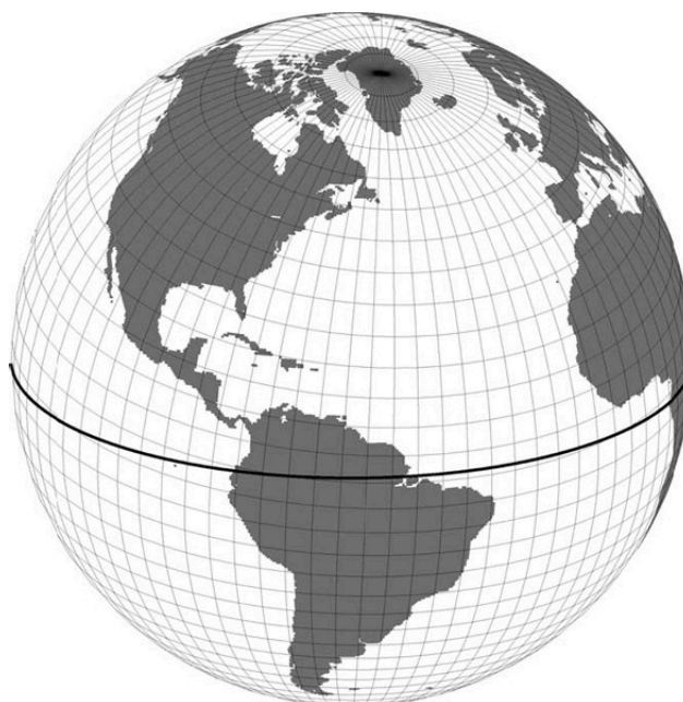
Рис. 2.5. Глобальный аналитический диполь с особыми точками, расположенными в 75^\circ с.ш., 40^\circ з.д. и в 90^\circ ю.ш. (преобразование всей сферы по методу [65]). Географический экватор отмечен жирной линией для сравнения.
