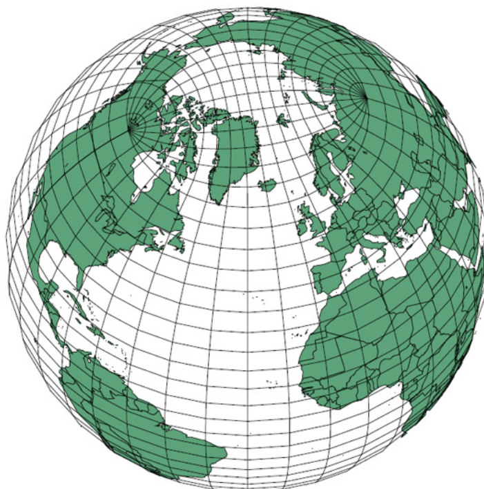
Рис. 2.3. Триполярная система координат [133], состоящая из двух сфер: основной – в большей части поверхности земли, и преобразованной – в полярной части Северного полушария.
