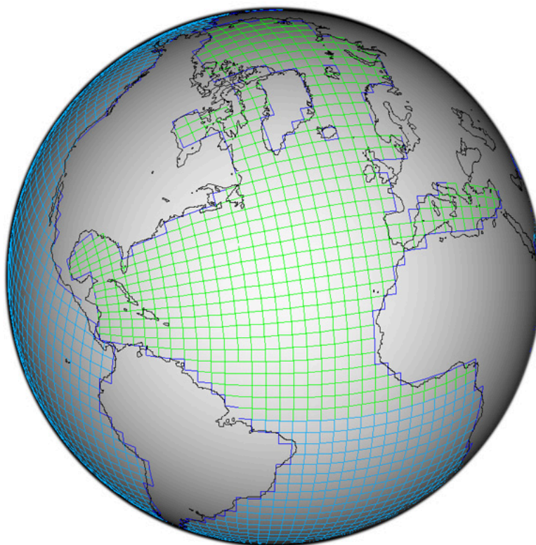
Рис. 2.2. Система координат, состоящая из геофизической (голубая) и повернутой (зеленая) сеток, объединенных на экваторе Атлантики, но не связанных в Беринговом проливе.
